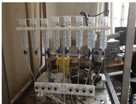
Figur 18: Flödessystem som användes i den elektrofysiologiska undersökningen. Kulori och kulori-moxifloxacinlösningarna fylldes på i sprutorna.
